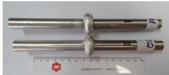
Figura 5. Pinos soldados por fricção com formação de “flash” [Fonte: ALVES, 2017]
